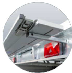
Heckklappenstütze mittels Auszugsrohren
